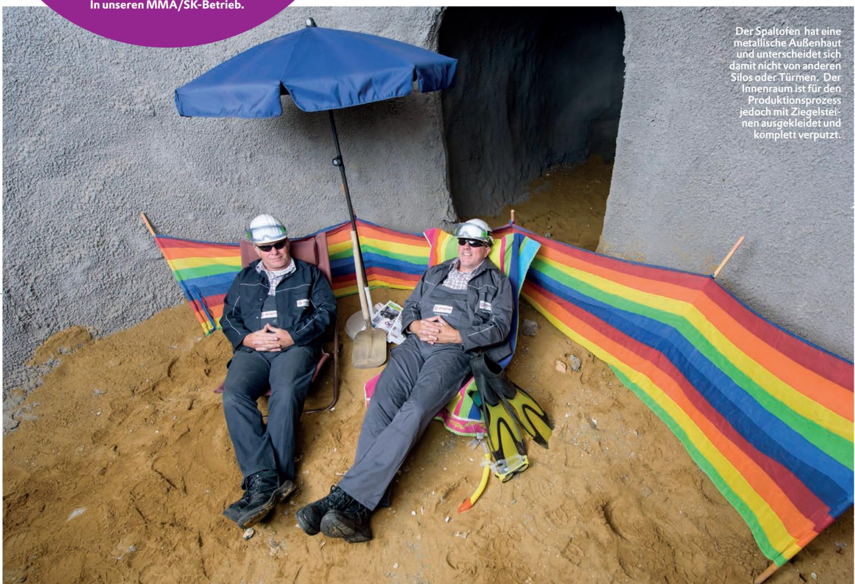
Der Spalt-ofen hat eine metallische Außenhaut und unterscheidet sich damit nicht von anderen Silos oder Türmen. Der Innenraum ist für den Produktionsprozess jedoch mit Ziegelsteinen ausgekleidet und komplett verputzt.
